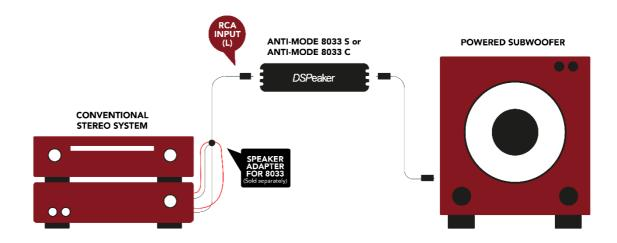
Der Anschluss des AM8033 an ein 2.1-System ohne Stereo- oder Mono-Vorverstärkerausgang ist ebenso möglich. Für diese Verbindung ist ein DSPeaker-"Lautsprecherpegel-zu-Linepegel"-Adapter erforderlich. Sie erhalten diesen über unseren Webshop.
