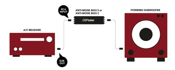
Standard-Heimkino-Konfiguration. Das AM8033 wird zwischen dem AV-Receiver / Vorverstärker (mit Subwoofer / LFE Ausgang) und dem Subwoofer angeschlossen.
