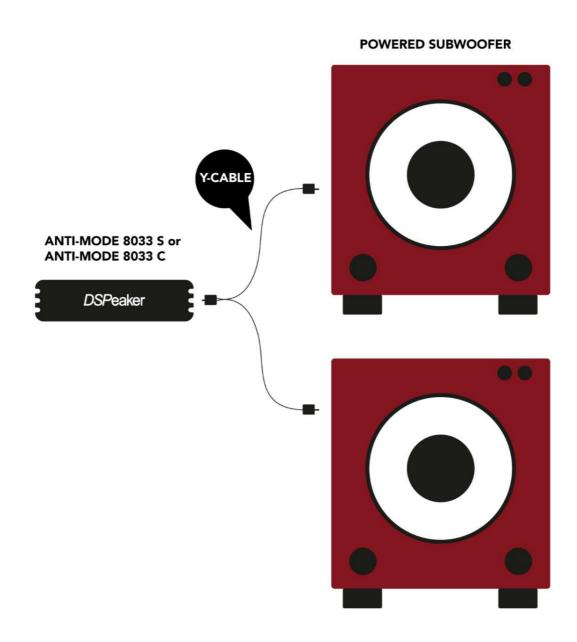
Der Anschluss von zwei Subwoofern (die das gleiche Mono- / LFE-Signal wiedergeben) an ein einzelnes **AM8033cinema** (oder s-II) kann mit einem Y-Cinch-Adapterkabel erfolgen. Wenn der / die Subwoofer eine invertierbare / einstellbare Phaseneinstellung hat / haben dann siehe das nächste Beispiel.
