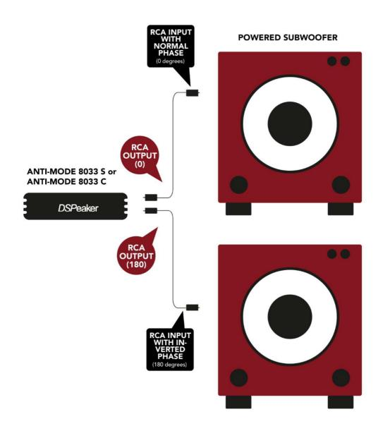
Der Anschluss eines einzelnen **AM8033s-II** an zwei Subwoofer (die das gleiche Mono- / LFE-Signal wiedergeben) kann durch Nutzung des sekundären 180°-Ausgangs des AM8033s-II erfolgen, allerdings nur, wenn der an diesem Anschluss eingesteckte Subwoofer über einen Phasenumkehrschalter oder eine einstellbare Phase von +/- 180° verfügt.
