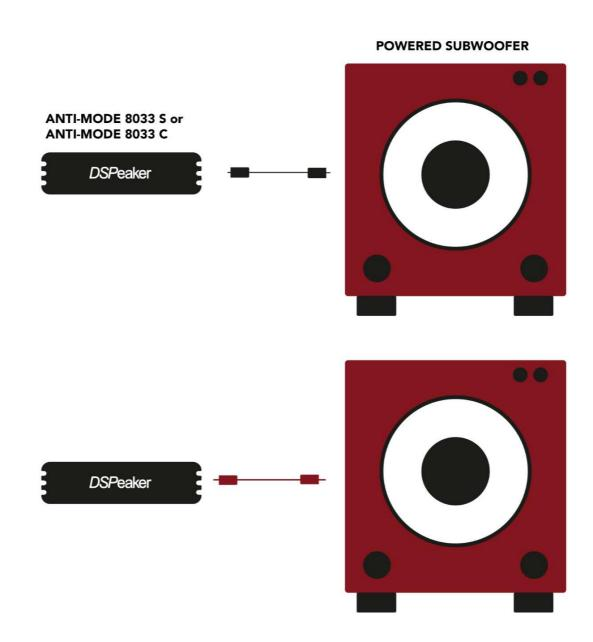
Anschluss des AM8033 an eine Anlage mit Stereo-Subwoofern. Diese Konfiguration erfordert zwei AM8033-Geräte, entweder AM8033s-II oder AM8033cinema.
