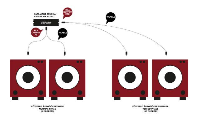
Ein einzelnes AM8033s-II kann sogar vier Subwoofer problemlos korrigieren, wenn der 0° und der 180°-Ausgang mit zwei zusätzlichen Y-Cinchkabeln genutzt wird.
