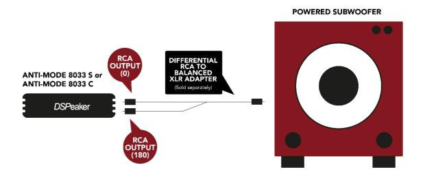
Wenn der Subwoofer symmetrische XLR-Eingänge unterstützt, ist es ratsam, den AM8033s-II über eine symmetrische Verbindung an den Subwoofer anzuschließen. Symmetrische Kabel unterstützen längere Kabelwege und sind unempfindlich gegenüber elektromagnetischen Einstrahlungen.
