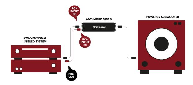
Anschluss des AM8033s-II an ein 2.1-System mit Stereo-Vorverstärkerausgängen über ein Stereo-Cinch-Kabel.
