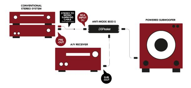
Hier der Anschluss des AM8033s-II an ein System mit zwei alternativen Eingangsquellen:
