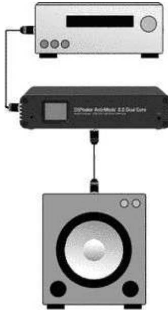
Bild 9. Anti-Mode 2.0 Dual Core für die Korrektur eines Subwoofers
